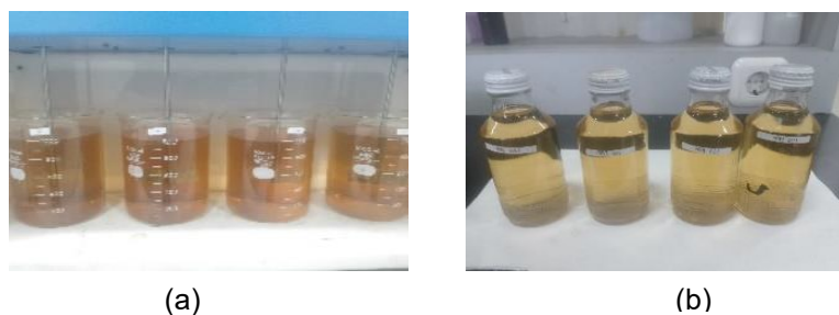
Gambar 4. Visualisasi hasil pengolahan koagulasi-flokulasi; (a) sampel sebelum koagulasi-flokulasi; (b) sampel setelah koagulasi-flokulasi
