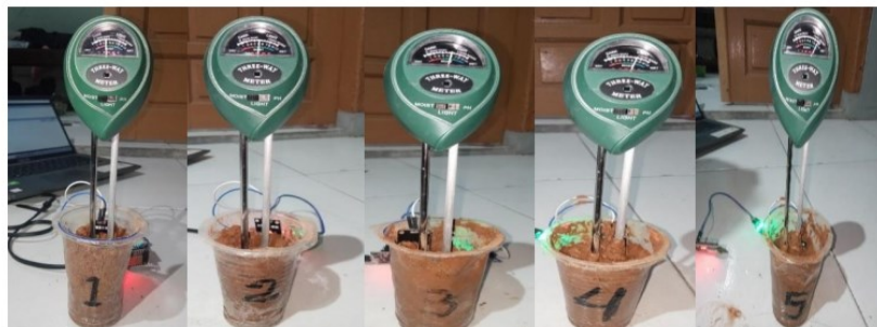
Gambar 7. Pengujian soil moisture sensor dengan alat ukur kelembaban tanah
