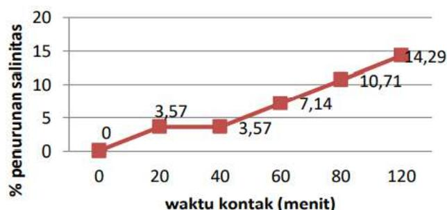
**Gambar 2.** Grafik hubungan waktu kontak terhadap % penurunan salinitas air
