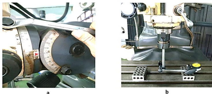
Gambar 1. Metode kalibrasi ketegaklurusan spindel terhadap meja kerja pada mesin milling
