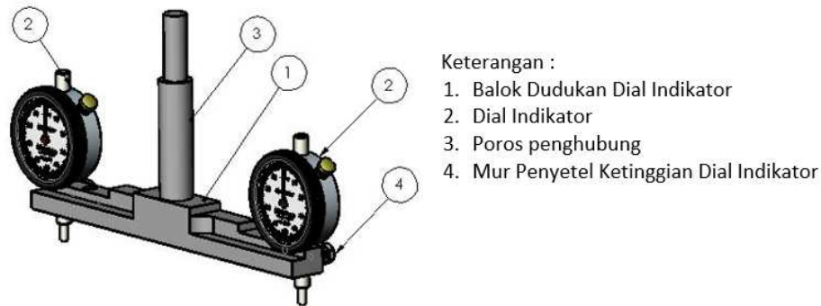
Gambar 4. Desain alat bantu kalibrasi ketegaklurusan spindel dan meja kerja pada mesin milling turret
