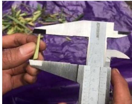
Gambar 3. Mengukur panjang rumput hasil pencacahan
