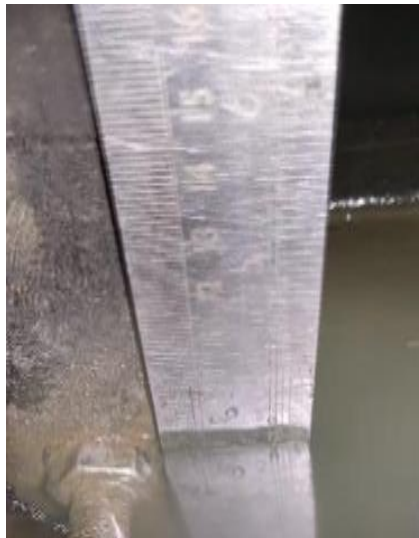
Gambar 4. Pengukuran tinggi air
