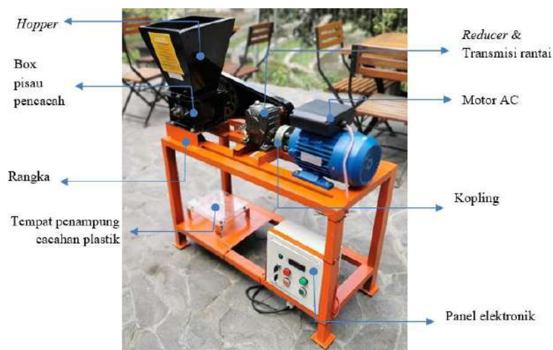
Gambar 3. Mesin pencacah sampah plastik
