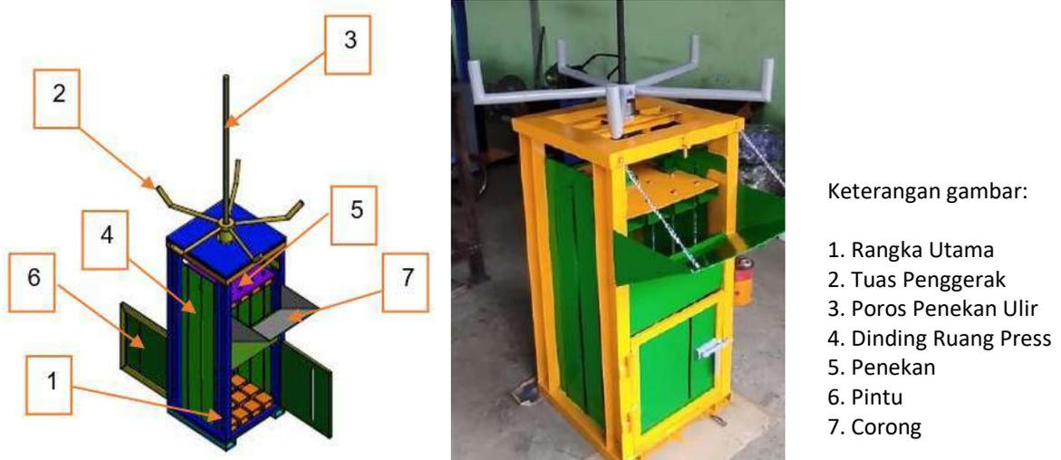
**Gambar 5.** Rancangan dan hasil manufaktur mesin press botol plastik
