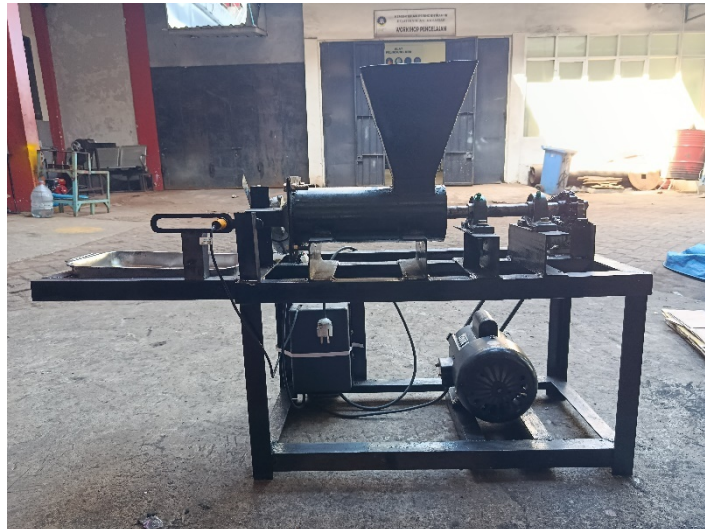
Gambar 2. Keseluruhan Mesin Pencetak Briket
