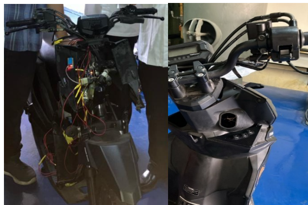
Gambar 6. Proses pemasangan sistem biometrik starter pada motor matik
