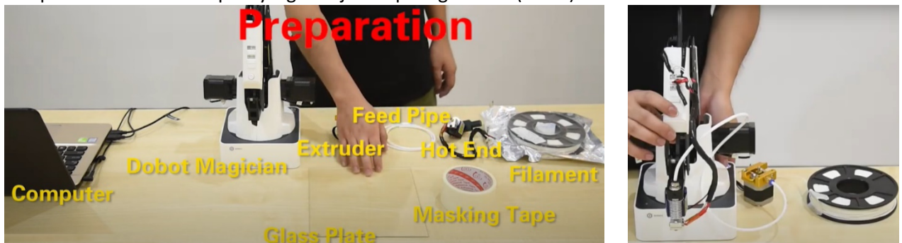
Gambar 3. Persiapan komponen (kiri) dan hasil pemasangan lengan robot untuk 3D printer (kanan) [8]
