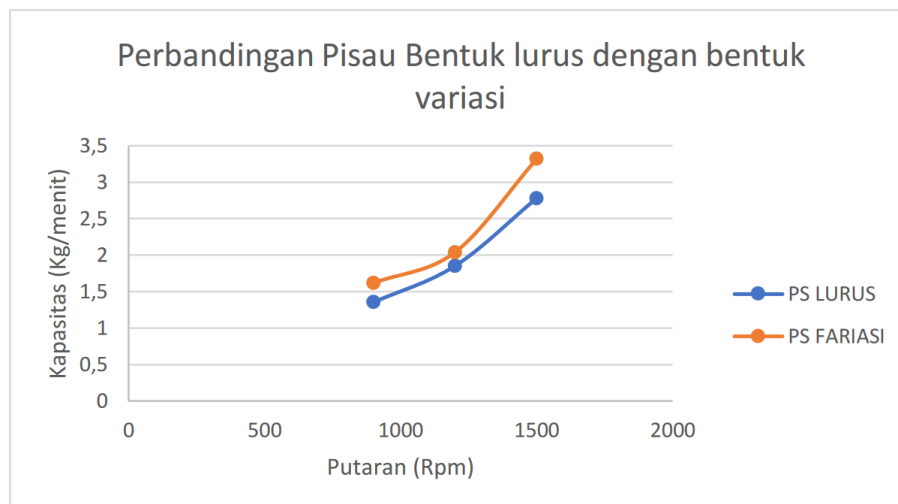
Gambar 4. Grafik perbandingan pisau bentuk lurus dengan bentuk variasi
