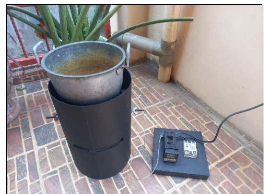
Gambar 2. Gambar Hasil Fabrikasi Kompor Biomassa Briket Kelapa Sawit
