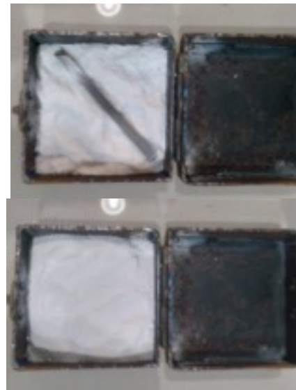
Gambar 3. Penempatan HSS di dalam box nitridasi yang telah diberikan serbuk ( \text{CO}(\text{NH}_2)_2 ) dan energizer
