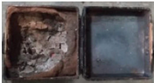
Gambar 5. Sampel setelah proses powder nitriding
