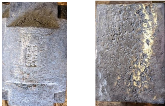
Gambar 1 Hasil cor sebelum pemesinan
