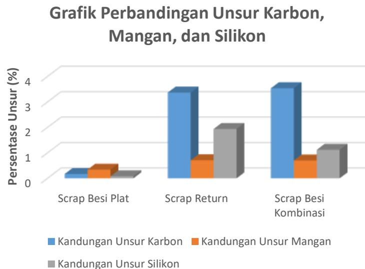
**Gambar 4.** Grafik perbandingan unsur yang memengaruhi nilai kekerasan pada besi cor
