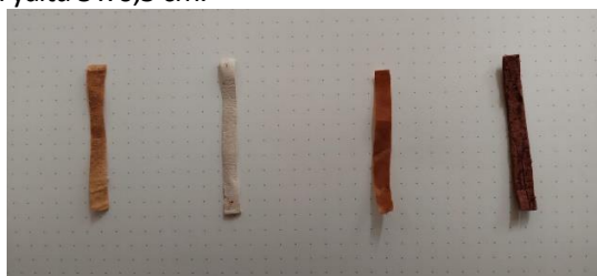
Gambar 5. Sampel Kulit yaitu kulit samak aldehyde, kulit chamois, kulit pickle, dan kulit samak nabati. (berurutan dari kiri ke kanan)
