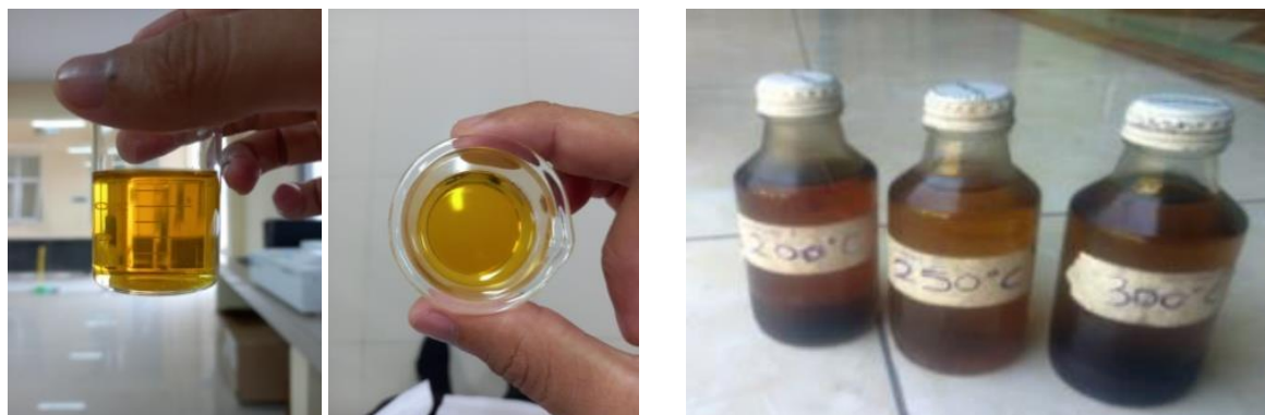
(a) Hasil penelitian ini (b) Wisnujati dan Yudhanto [14] Gambar 4. Perbandingan warna bahan bakar alternatif hasil Pirolisis LDPE
