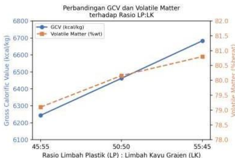
Gambar 5. Grafik Perbandingan Gross Calorific Value dan Volatile Matter terhadap Rasio LP:LK
