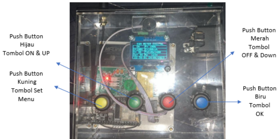
Gambar 5. Alat Sistem pengukuran dan pemantauan konsumsi energi listrik
